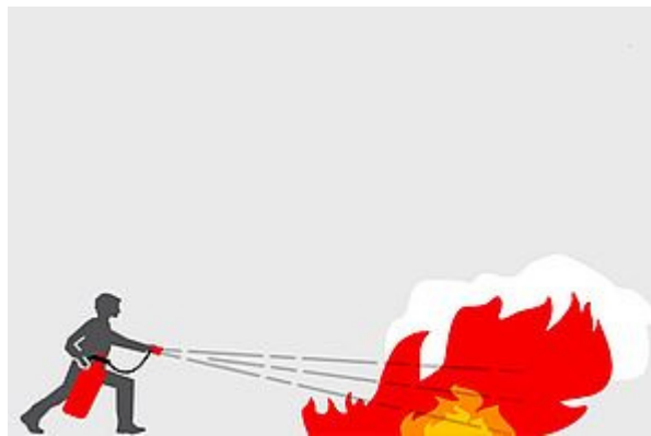
Stoß-weise löschen. Nur so viel löschen wie nötig.
