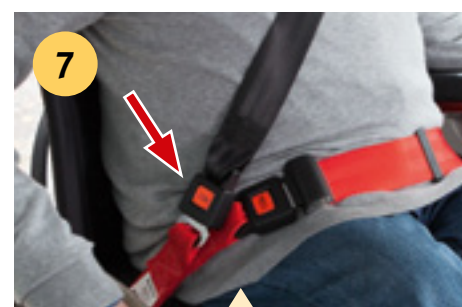
Gurtschloss des Schulterschräggurtes (schwarzer Gurt) in Schließung des Beckengurtes (roter Gurt) einklicken (Abbildung 7)
