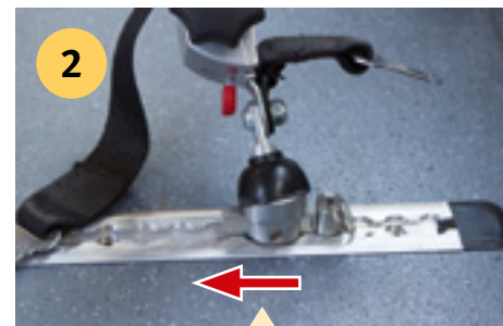
Die vier Spanngurte in die passenden Bodenschienen einrasten (Abbildungen A und B)
