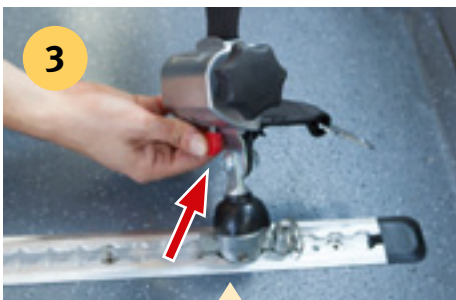
3 Ausziehen der Spanngurte aus den Retraktoren durch Betätigung des Arretierungsknopfes (Abbildung 3)
